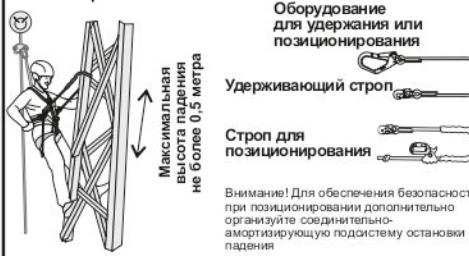
Рис. 10. Позиционирование в рабочем положении
