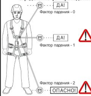
Рис. 7. Графическая схема к определению фактора падения
