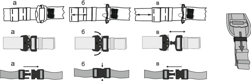
Рис. 6. Надевание привязи «Энерго»
