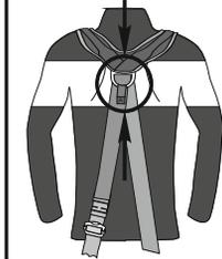
Рис. 9. Соединительно-амортизирующая подсистема
