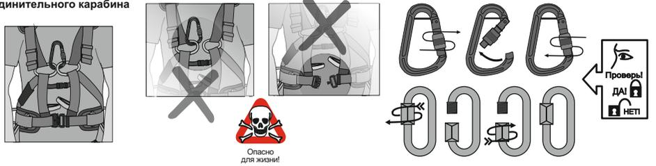
Рис. 5. Типы используемых пряжек, способы заправки
