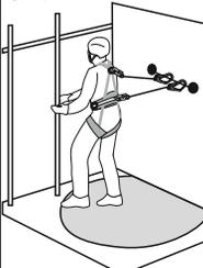
Рис. 13. Позиционирование в рабочем положении
