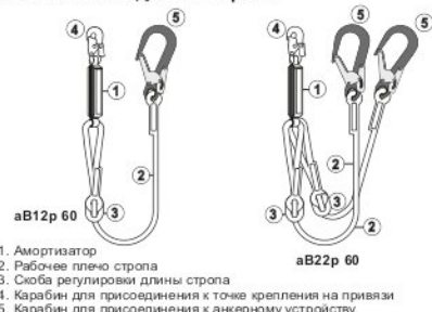
Рис. 1. Внешний вид, состав стропов
