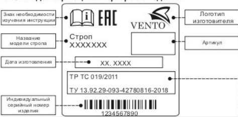
Рис. 2. Идентификация и маркировка изделия
