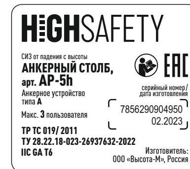
Рис. 2 Маркировка анкерных столбов.
