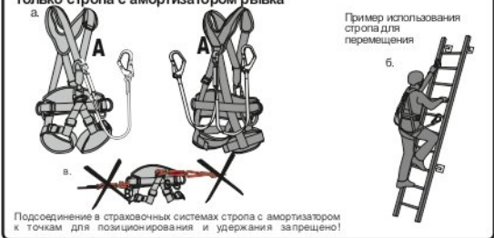
Рис. 6. Использование карабинов, входящих в состав стропов
