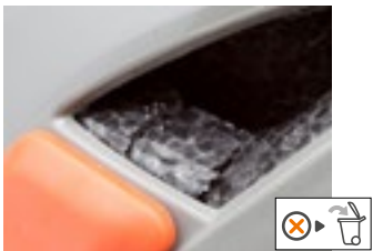
• Трещина в оболочке каски
