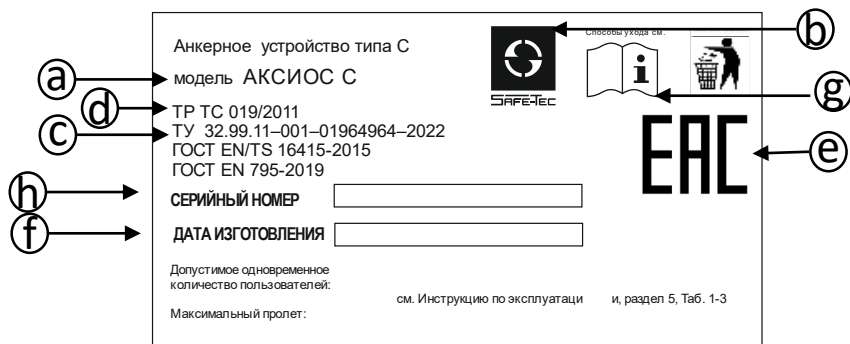
Рис. 1 Пример маркировки анкерной линии АКСИОС С
