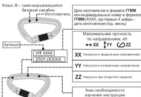
Рис. 2. Идентификация и маркировка изделия
