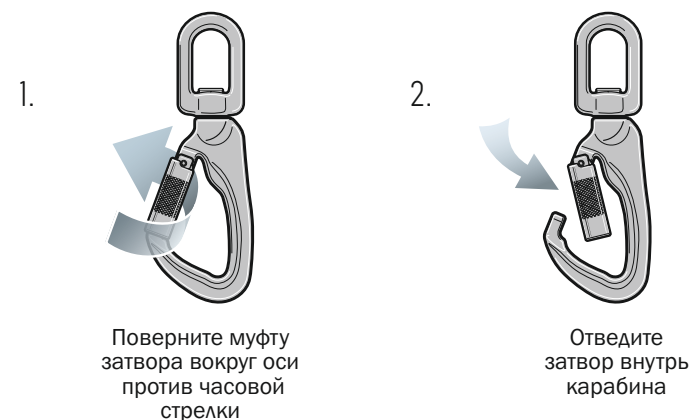
Рис. 3 Принцип работы карабина класса Т.
