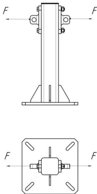
Установка вспомогательной металлоконструкции должна проводиться в соответствии с правилами выполнения механических и строительных соединений. Учитывайте условия окружающей среды, преобладающие в месте установки, которые могут послужить причиной коррозии вспомогательной металлоконструкции и соединителей.
