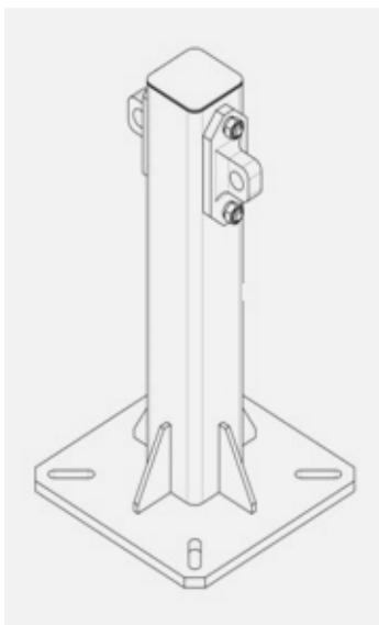
POST 1 выполнена в виде столбика с закрепленными на верхней части анкерными точками, служащими для присоединения соединительно-амортизирующей системы обеспечения безопасности работ на высоте. Вспомогательная металлоконструкция предназначена для работы с одним или двумя пользователями.
