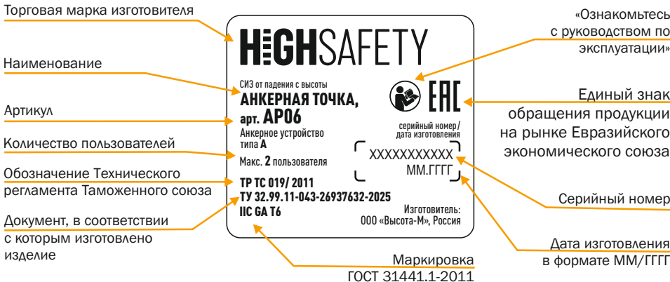
Рис. 2 Маркировка анкерной точки арт. АР06.
