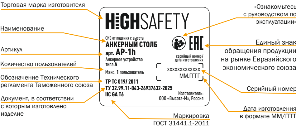
Рис. 2 Маркировка анкерного столба AP-1h.
