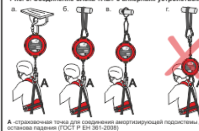
Рис. 5. Общие принципы использования карабинов
