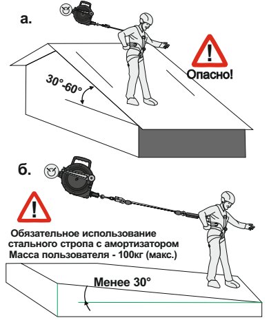
Рис. 9. Использование на горизонтальных и наклонных поверхностях
