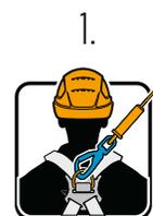
Используйте точки крепления на привязи для соединения СЗВТ, соответствующие стандарту ГОСТ Р ЕН 361-2008 (EN 361:2002)
