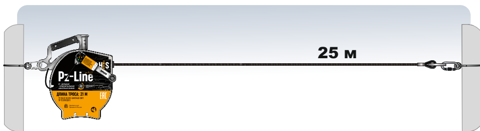
Рис. 2 Установка анкерной линии на всю ее длину (25 м).
