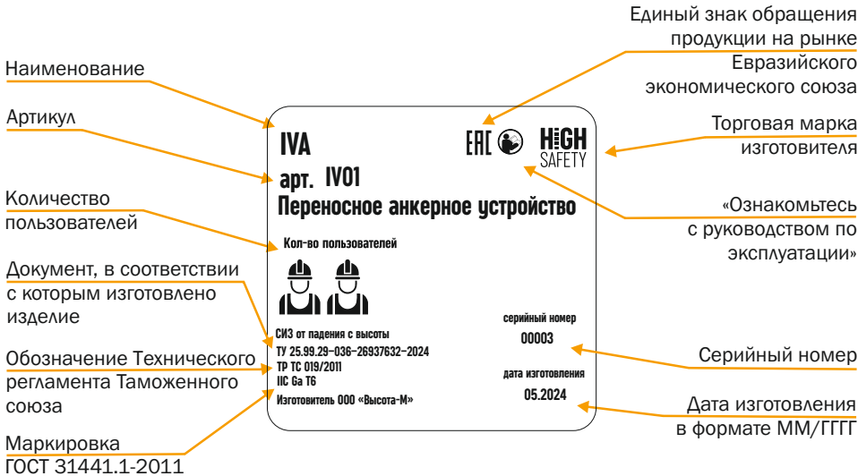
Рис. 3 Маркировка переносного анкерного устройства IVA.
