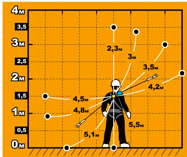
Рис. 11 Расчет минимальной высоты (запаса высоты) рабочего места в зависимости от положения анкерного устройства относительно пользователя.
