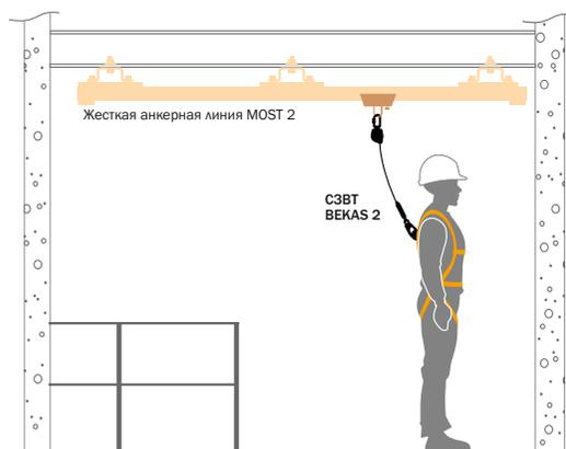
**Рис. 2** Использование СЗВТ с анкерным устройством (пример).
