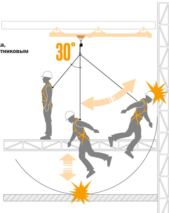
В фактор маятника должно быть включено возможное перемещение стропа по кромке от точки 1 до точки 2 с истиранием до разрыва, вызываемое маятниковым перемещением работника при его падении (рис. 8). Чтобы этого избежать, работайте непосредственно под местом анкерного крепления или как можно ближе к нему (отклонение троса от вертикали не более  $30^\circ$ ).
