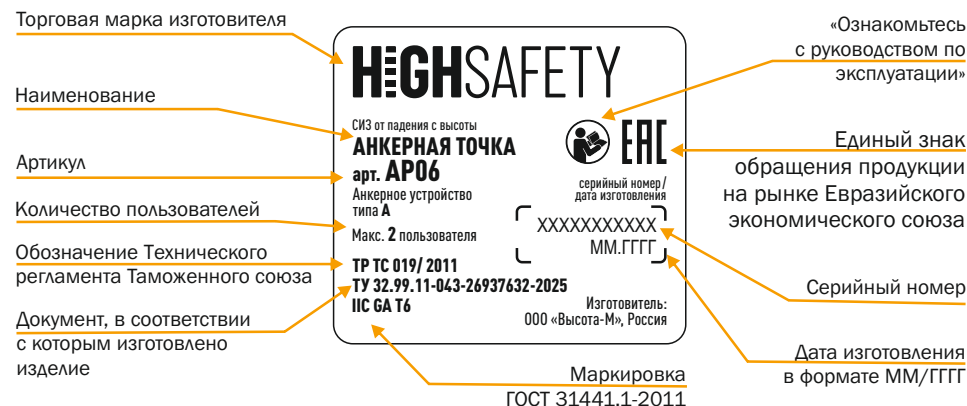
Рис. 1 Маркировка анкерной точки АР06.
